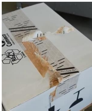
封函済み品の密着性損傷模擬試験
